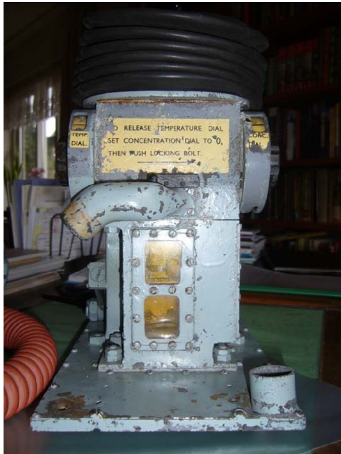
Afb. 1 De robuust uitgevoerde ESO-chloroforminhalator, met aan weerszijden de knoppen voor concentratie en temperatuurcompensatie (foto M. Buwalda)
